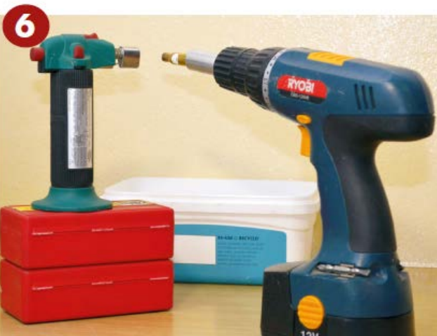
Hier is die uitgloeitoerusting opgestel: die boor met die dophouer en die gasvlam.
