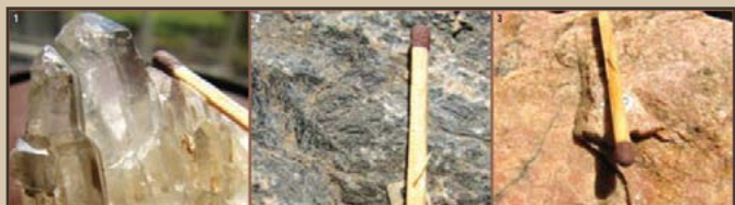
Figuur 1: Kwarts is die algemeenste mineraal van die silikaatgroep en bied uiterste weerstand teen verwerking. Figuur 2: Die swart mineraal is hoornblende en is deel van die amfiboolgroep. Figuur 3: Die pienk mineraal is ortoklaas en is deel van die veldspaatgroep.
