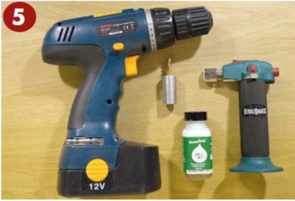
Uitgloeitoerusting: 'n boor, dophouer, Tempilaq en 'n gasvlam.
