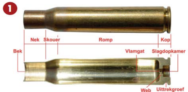
Op die foto word al die verskillende dopdele aangedui. Dit is waar elke dop oral geïnspekteer moet word vir krake of ander defekte voor gebruik.
